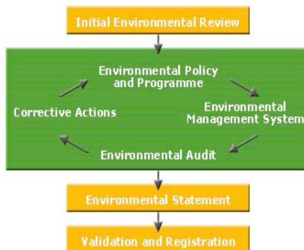
Figura 4-2 Lo schema di ecogestione ed audit previsto dal Regolamento n. 761/2001 (dal sito ufficiale EMAS della Commissione Ambiente della UE): Initial Environmental Review = Analisi Ambientale Iniziale ; Environmental Policy and Programme = Politica Ambientale e Programmi; Environmental Management System = Sistema di gestione Ambientale; Environmental Audit = Audit Ambientale; Corrective Actions = Azioni Corretive; Environmental Statement = Dichiarazione Ambientale; Validation Registration = certificazione e registrazione.
